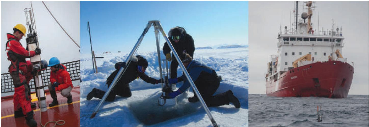
**Figura 4.** *Izquierda:* preparación de un flotador biogeoquímico Argo para su lanzamiento. *Centro:* un flotador es liberado a partir de la banquisa. *Derecha:* un flotador emerge en un área libre de hielo. Fuente: Pascaline Bourgain y Claudie Marec.
