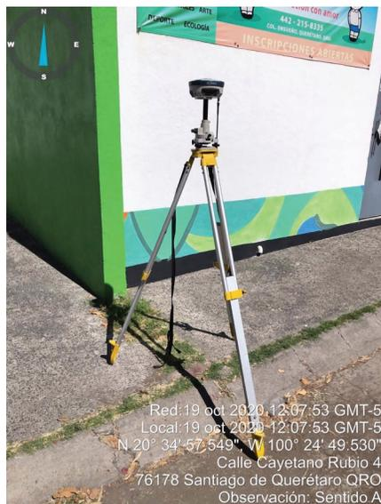
Figura 7. GCP-1 y GRX2 GPS utilizados
