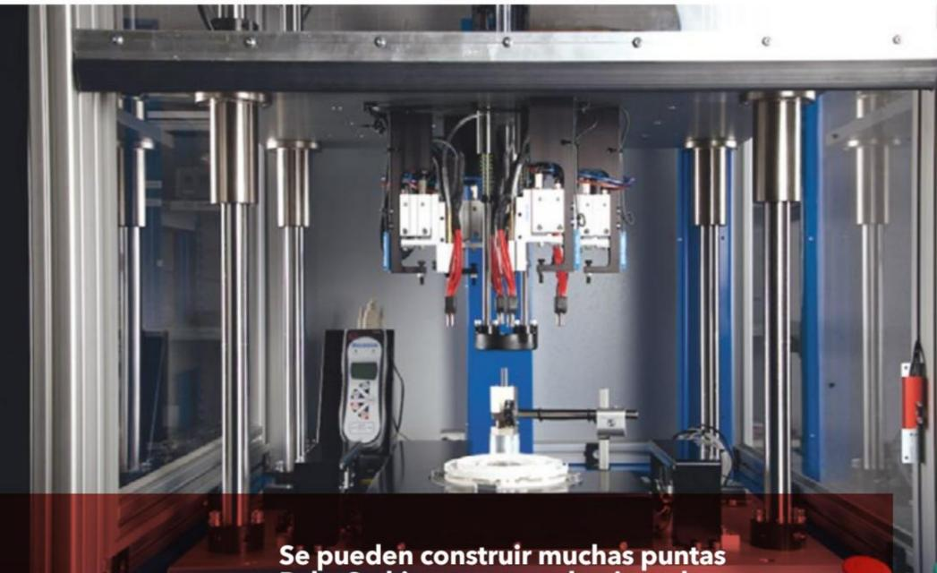
**Se pueden construir muchas puntas PulseStaking en una sola pieza de herramienta, permitiendo realizar múltiple remaches o conformados en una sola operación sobre piezas simples o geométricamente complejas, tanto grandes como pequeñas.**
