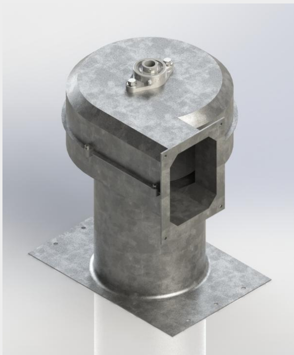
Figura 7. Módulo de separación de residuos (elaboración propia)
