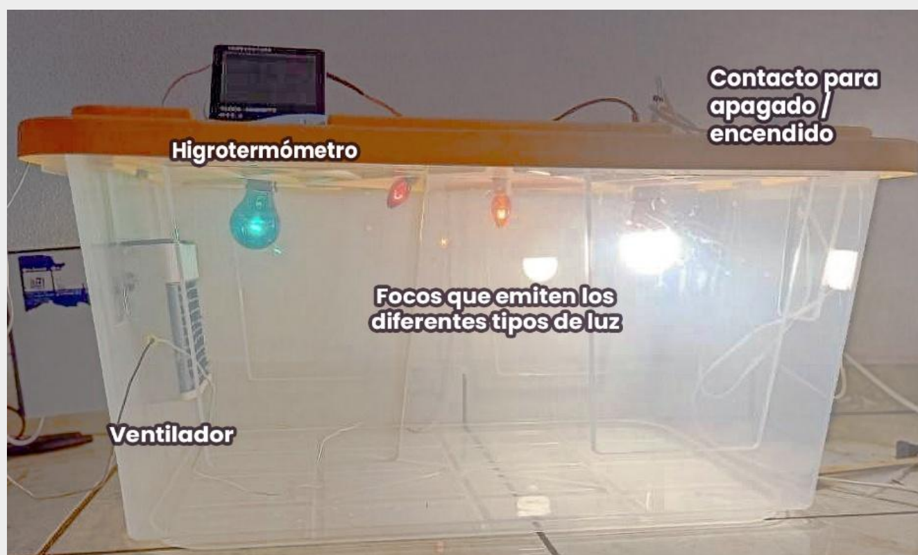
Figura 2. Cámara de germinación terminada, la cual contiene focos con diferentes tipos de luz, ventilador, higrotermómetro (elaboración propia)
